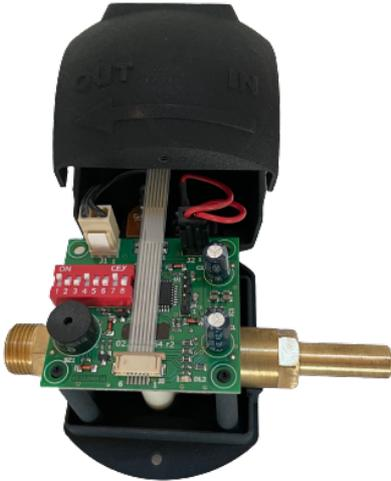
Flow-Counter an der Rückseite mit einem Schraubenzieher öffnen. Schwarzen Deckel vorsichtig anheben. Nun sind die DIP Switch Schalter zugänglich und können eingestellt werden. Deckel anschliessend wieder verschrauben. Der Flow-Counter ist jetzt betriebsbereit.
